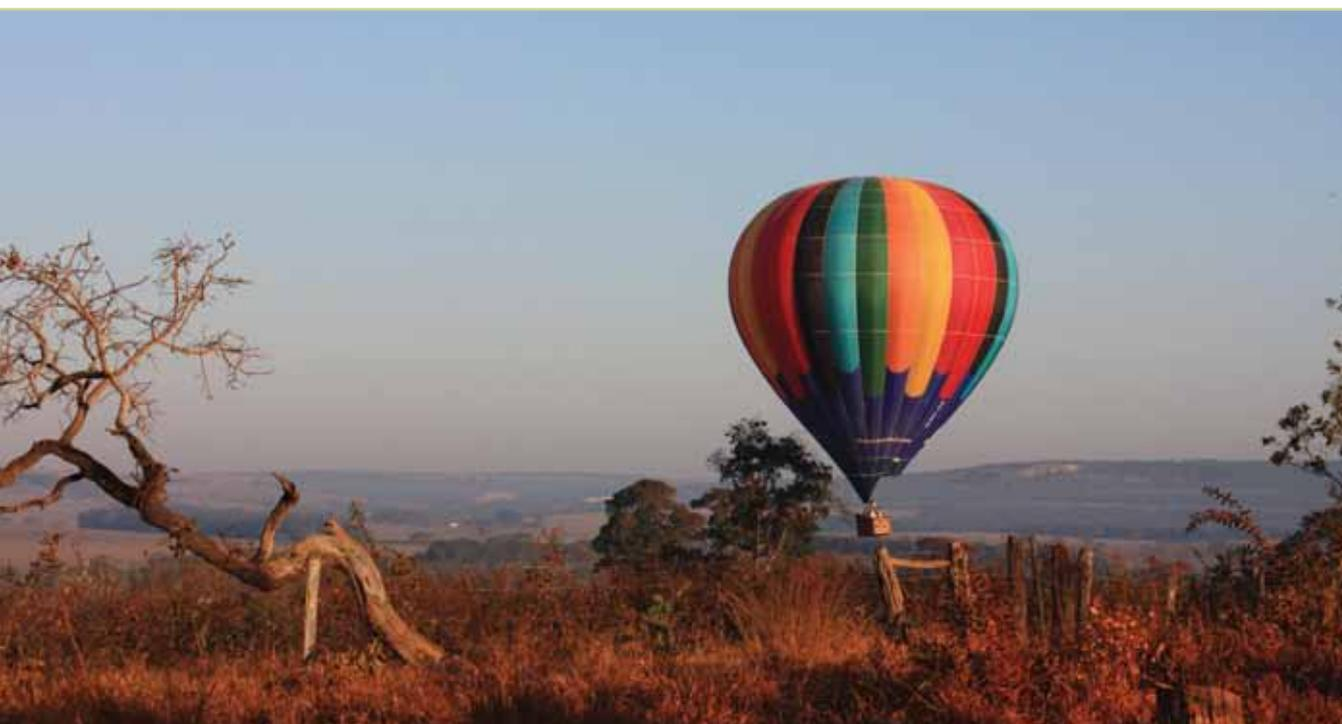
O balonismo é definido como uma atividade aérea feita em um balão de material anti-inflamável aquecido com chamas de gás propano. O controle da descida e subida é feito pelo balonista (o piloto), que controla local de decolagem e pouso e utiliza os ventos para se deslocar. A altitude ideal para se voar é de 330m, mas pode-se chegar até 16 mil metros.
