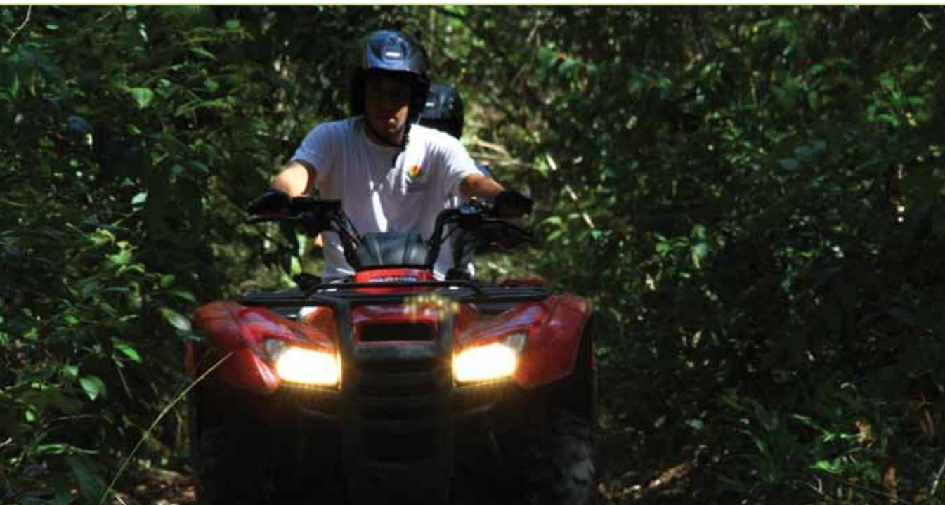
Quadriciclos são veículos de pequeno porte, motorizados, abertos, com quatro rodas, fabricados para uso em ambiente fora-de-estrada (*off-road*) e para uma pessoa, podendo, algumas vezes, ter um segundo assento (caso o equipamento seja equipado, de fábrica, para dois passageiros).
